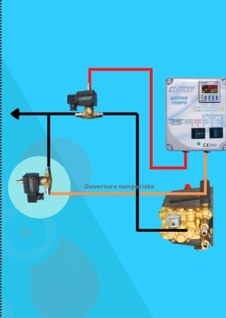
**Pack électrovanne 3 voies pour une décharge anti-goutte de circuit HP avec ouverture temporisée:**
